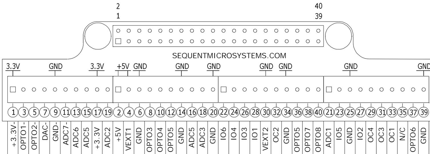
MEGA-IO BREAK-OUT CARD PINOUT
