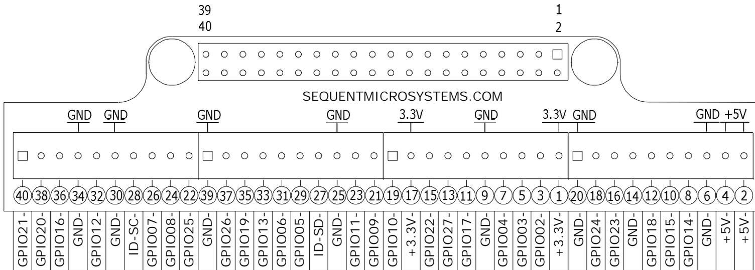
RASPBERRY PI BREAK-OUT CARD PINOUT
